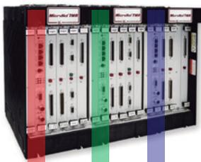
Triple Module Redundant (TMR)
